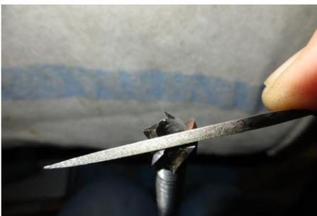
Mit dem Kegelschleifstift von Hand die Nebenschneiden schärfen.
